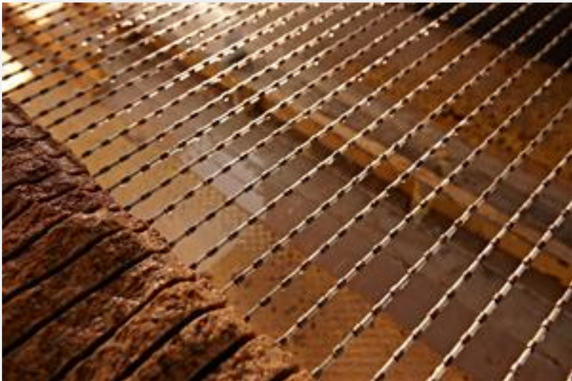
Figura 35 - Foto de uma máquina de corte multifio em operação. Fonte: DIAMONT-BOARD (dez/2012).
