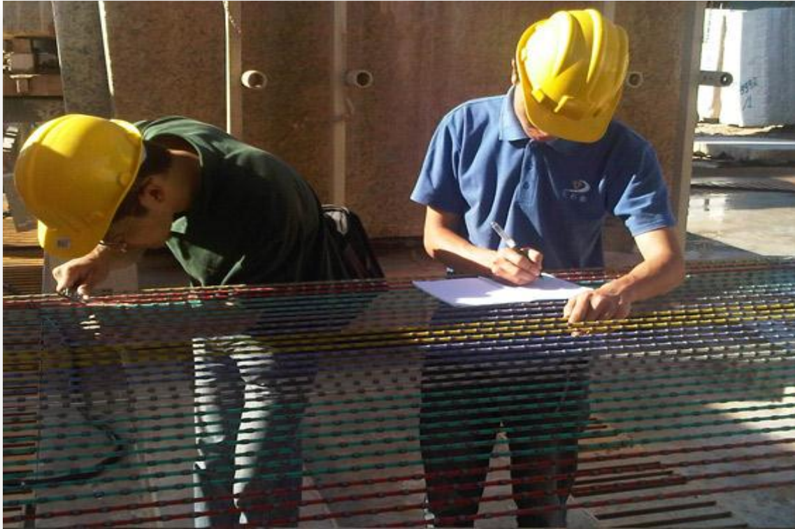
Figura 36 - Foto de operários verificando diâmetros das pérolas de um tear multifio.
