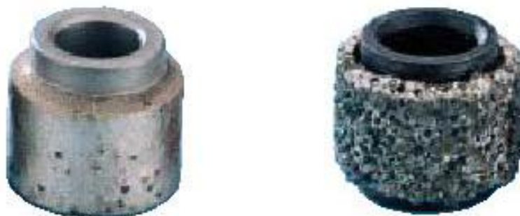
Figura 14 - Aspecto de um anel sintetizado (esquerda) e de um eletrodepositado (direita).
