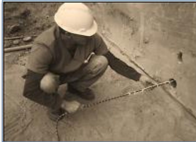
Figura 29 - Foto de inserção do fio diamantado com auxílio do fio de nylon e ar comprimido.
