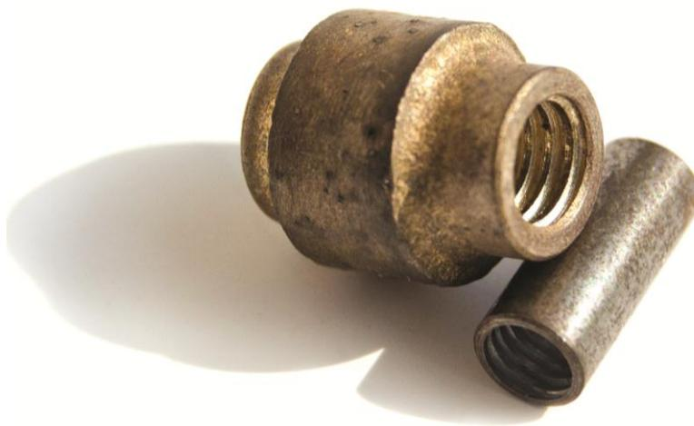
Para o dimensionamento do tubo suporte é necessário conhecer as dimensões do anel e do cabo de aço. O diâmetro externo do tubo suporte encaixa na parte interna do anel, portanto, os mesmos devem coincidir, com uma pequena folga entre eles. Já o diâmetro interno do tubo suporte encaixa na parte externa do cabo de aço, devendo-se fazer também coincidir estes dois diâmetros, com uma pequena folga entre eles, visando facilitar a montagem do conjunto anel-tubo no cabo de aço.
