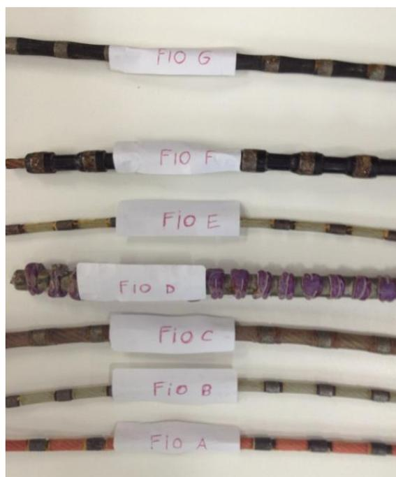
Além do teste de queima, também foi realizado teste de densidade das amostras. Porém, devido às amostras advirem de fios diamantados utilizados no processo de corte, os resultados obtidos não são confiáveis. Portanto, este teste foi desconsiderado.
