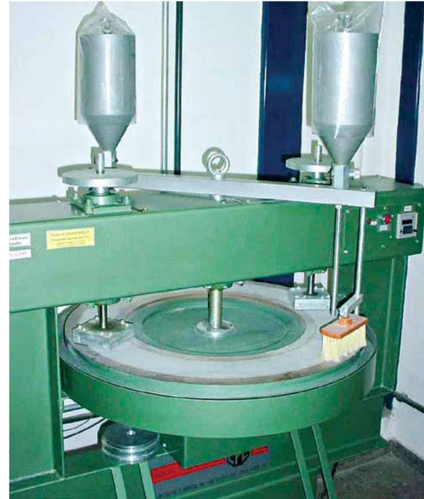
FOTO 16 Equipamento para ensaio de resistência à abrasão (Amsler). Fonte - LMTR - CIENTEC - RS
