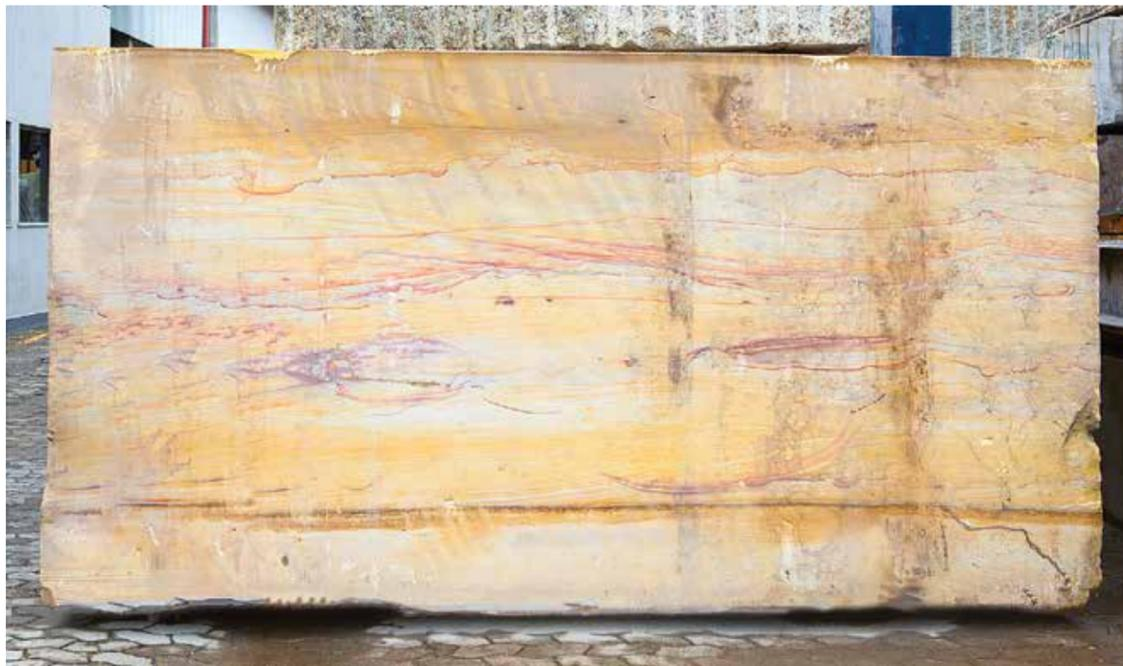
FOTO 23 Bloco de granito extraído com fio diamantado
