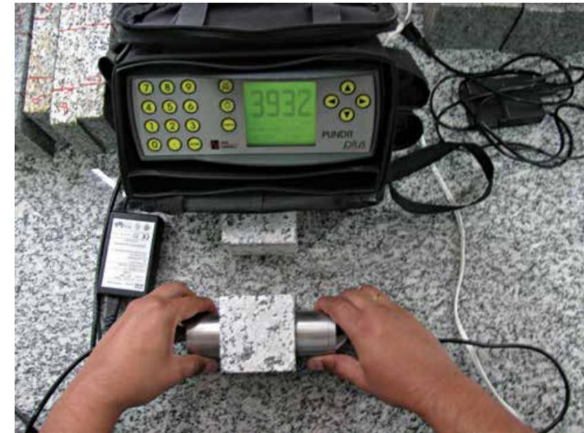
FOTO 17 Equipamento para determinação da velocidade de propagação de ondas ultrassônicas em rocha granítica. Fonte - CETEM-MCTI
