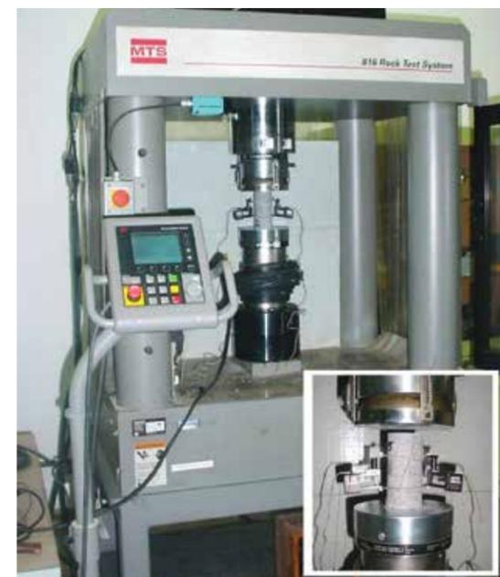
FOTO 10 Ensaio de compressão uniaxial. Fonte - LMTR -CIENTEC -RS
