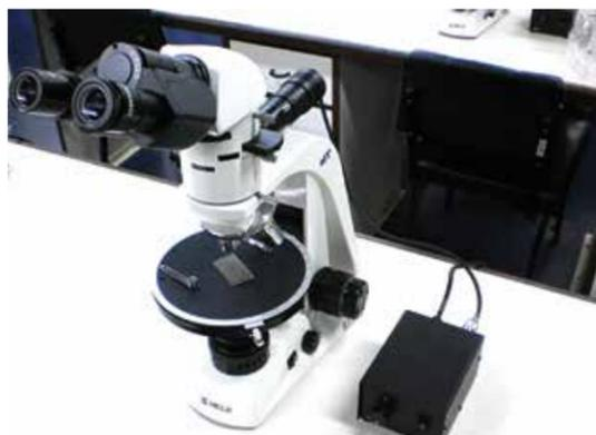
FOTO 9 Observação de lâmina em microscópio petrográfico. Fonte - DEMIPE-UFRGS
