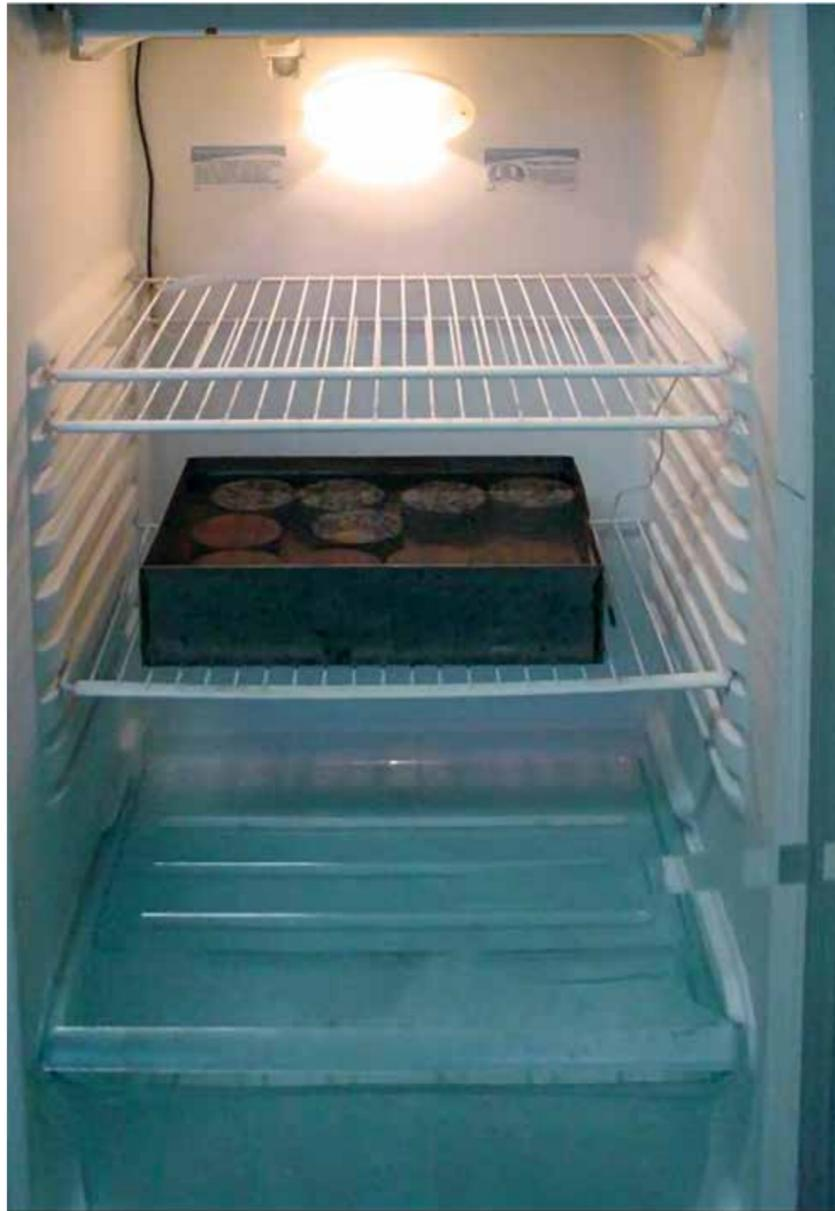
FOTO 11 Equipamento para ensaio de alterabilidade por congelamento e degelo. Fonte: LMTR-CIENTEC-RS
