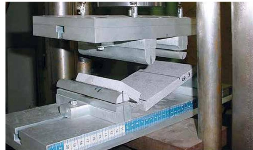
FOTO 13 Detalhe de corpo de prova rompido - Carregamento em Quatro Pontos. Fonte - LMTR-CIENTEC-RS
